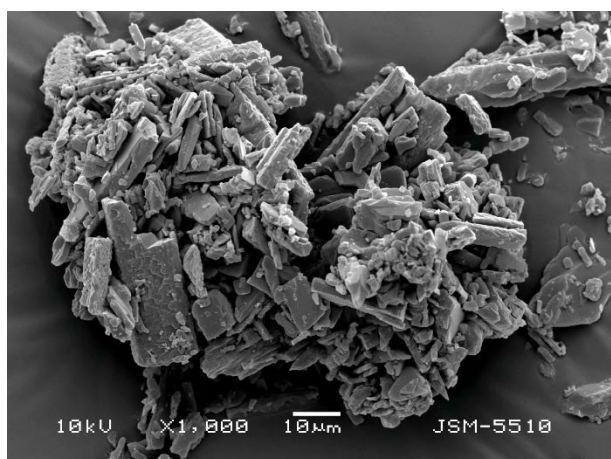
Fig. 4. SEM micrograph of pure curcumin.
