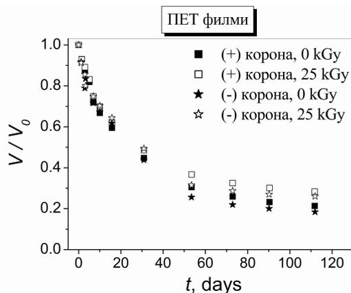
Фиг. 2. Времеви зависимости на нормирания повърхностен потенциал за необлъчени и  $\gamma$ -облъчени ПЕТ образци.
